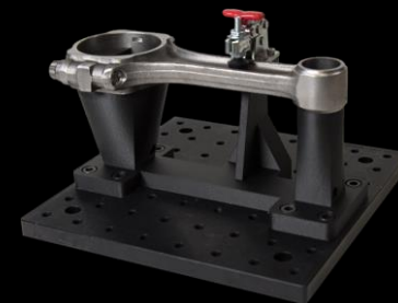
Fixations d'inspection/contrôle MarkForged: 80€ - Usinage: 800€
