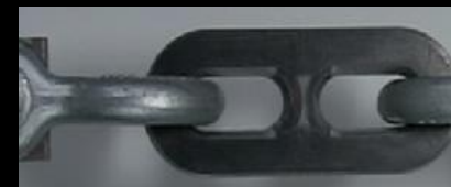
Maillon de chaîne imprimé avec fibre longue de carbone: 11 tonnes en traction avant rupture
