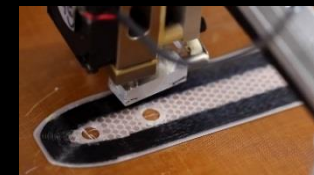
Impression de fibre longue de carbone prise en sandwich dans du nylon
