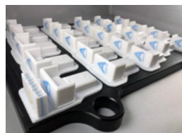
Production en petites séries de protection d'angles de convoyeurs
