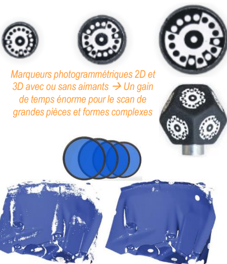
Scan réalisé sans et avec les filtres de lumière bleue
