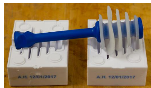
Impression 3D de moule silicone avec marquage de numéro de série
