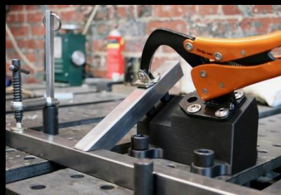
Fixations de soudure MarkForged: 60€ - Usinage: 500€
