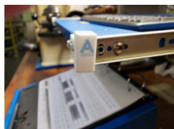
Production en petites séries de protection d'angles de convoyeurs
