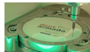
Couronne anatomique en Zircon: 9min Couronne anatomique en Céramique: 16min
